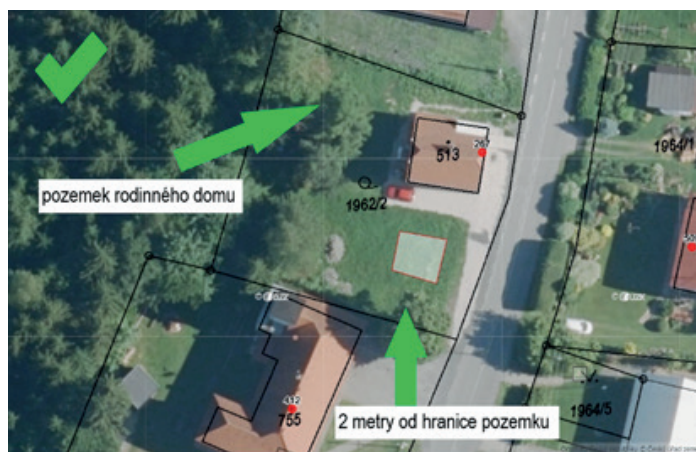
Stavba do 40m 2 na pozemku hlavní stavby a více jak 2 metry od hranice - bez povolení.
